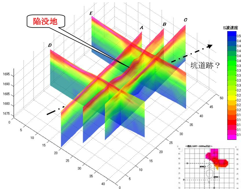
深部の凹状低速度部が、緩み領域と推定され、ボーリングにより坑道跡と確認された。
