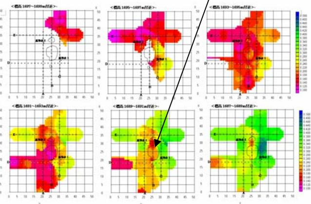
S波速度分布の特徴から、陥没を発生させた緩み領域を3次的に推定する
